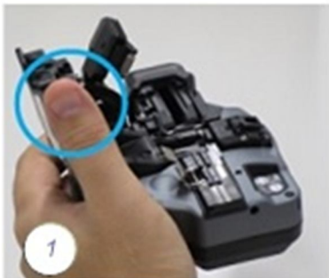
1 Primi CT50 sa strane PAŽNJA: ne diraj stezaljku niti
